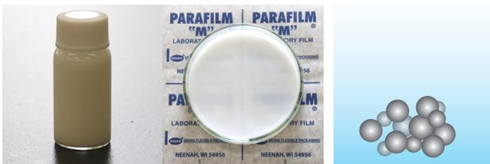
一般的に酸化チタンは凝集しやすい物質のため、分散液中に二次凝集体が残り、液や薄膜に濁りが生じます。
