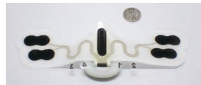
信越化学のウェアラブルデバイス向け材料が使われたヘルスパッチ。黒い部分が生体ドライ電極、それらをつなぐ金色の線が高伸縮性配線
