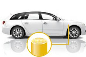
地球温暖化防止に貢献する自動車の排ガス浄化装置の成型を助ける結合剤として使われています。
