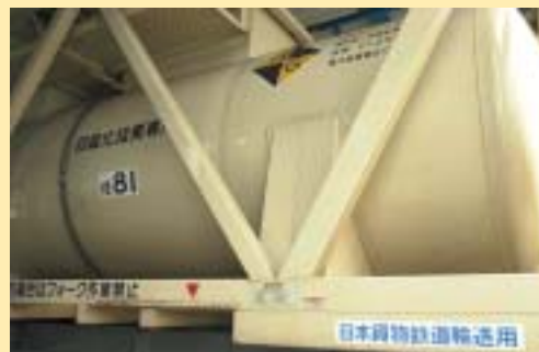
トラック・鉄道輸送併用型のタンクローリー
